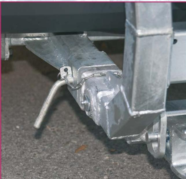
Der Rohrhalter wird am Fahrzeug montiert und dient zur Aufnahme des Pfluges. Der Pflug kann mit wenigen Handgriffen vom Fahrzeug ab- und angebaut werden und wird mittels Steckbolzen gesichert.
