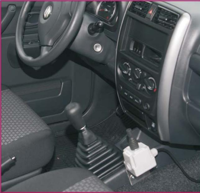
Der Pflug lässt sich bequem vom Fahrzeuginneren aus mittels Bedienteil/Joystick bedienen.
